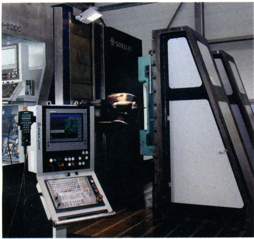
Nur rund 2,5 min dauert der Wechsel von einem horizontalen Fräsvorsatz zu einem Orthogonalkopf.
