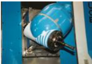
Bild 2: Die Werkzeugverrechnung beim automatischen Schwenken des Fräskopfes erfolgt über die Maschinensteuerung und bietet dem Bediener ein Höchstmaß an Komfort
