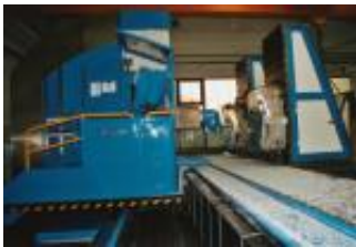
Bild 1: Die neue Hochgeschwindigkeits-Starrbettfräsmaschine der SV-Baureihe im Einsatz beim Anwender
